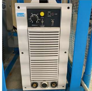
プラズマ切断機
