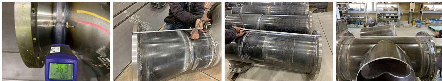
溶接が終了した配管の形状、寸法を図面と照らし合わせ最終検査を行います。
