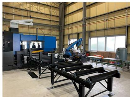
自社独自のカットリストではスプールごと、材質ごとに別々でリスト化しております。これにより切断等のヒューマンエラーを防止するとともに、PIPEのロス無くし、作業効率を上げコスト削減にも繋がります。また弊社のカットマシンは切削油をミスト化させておりますのでお客様の大切な素材に無駄な油分をかけないようにして品質を保っております。
