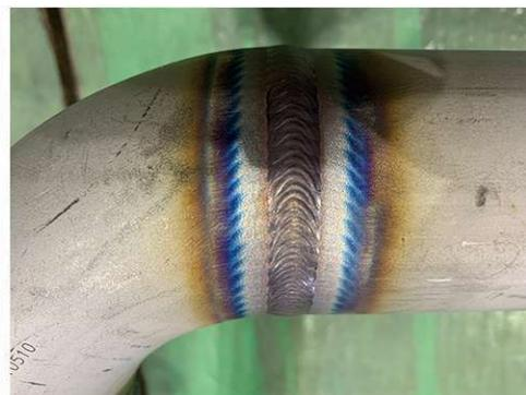
有資格者による品質精度の高い溶接を行います。溶接棒の保管を徹底管理し材質間違いによる溶接欠陥防止に努めております。裏波溶接が必要な配管につきましてはバックシールドガスを濃度測定器による測定後に高品質な裏波溶接を行います。
