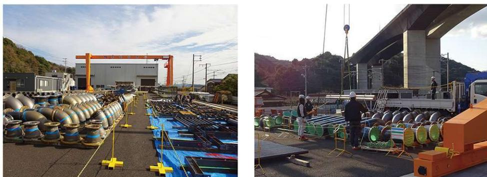
SUS製とCS製の接触部のもらいサビを防止する為、直接触れないよう積みみます。
