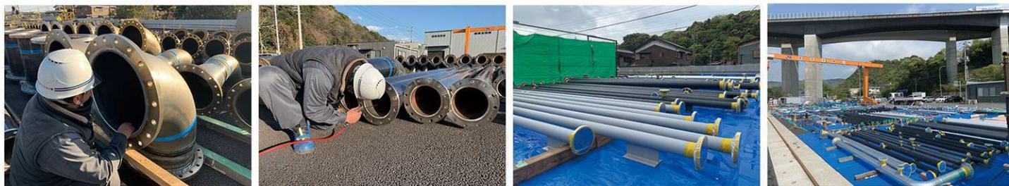
出荷前の最終工程では内部の異物混入をエアークッションと目視検査により確認しております。
