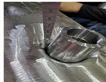
製作図、施工要領書をもとに溶接工程が限りなく下向き姿勢で行えるよう順序を計画して組立てます。また歪み等による形状不良が起らないよう独自のノウハウを取り入れ品質保持に努めております。
